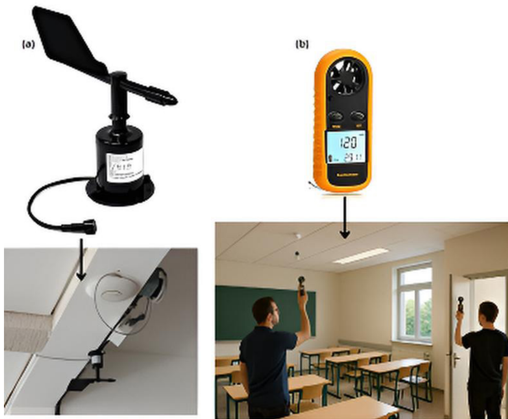
Figura 4 – (a) Sensor de direção do vento VMS-3000-FXJT-N01 instalado no corredor central; (b) Anemômetro digital manual AR816 utilizado para medições complementares
