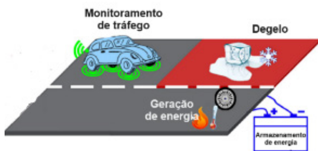
Figura 18 – Exemplos de aplicações em infraestrutura de pavimentos com compostos multifuncionais
