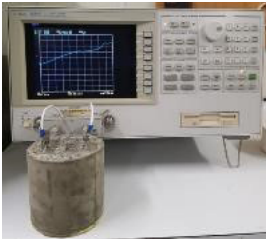
Figura 9 – Utilização de analisador de impedância em compósito cimentício com dois eletrodos metálicos embutidos
